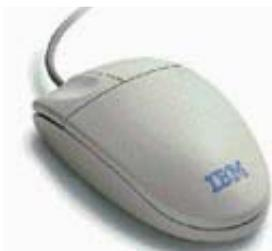
**b) La souris** : dispositif de pointage. Il devient indispensable pour tous les environnements graphiques vu la facilité qu'il apporte. Une souris est composée d'un système de repérage (mécanique ou optique) et un système de commande souvent avec deux touches et parfois avec une roulette. La souris, comme le clavier, utilise un **port série** pour se brancher à l'ordinateur. La communication se fait par fils, par infrarouge ou par onde radio.
