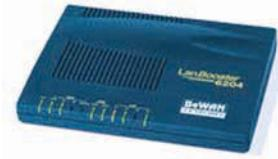
Il peut être matériel (Fig 1.5) ou logiciel. Dans les deux cas, le pare-feu est activé à l'entrée du système à protéger. Il filtre aussi bien le flux entrant que le flux sortant. Il peut ainsi empêcher l'accès à certains sites et domaines d'un réseau comme celui d'Internet ou interdire à un utilisateur certains services comme la messagerie ou le transfert de fichiers.
