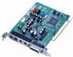
**b) La carte son** : capable de convertir des signaux numériques en signaux analogiques et inversement, elle permet de brancher un microphone, des enceintes acoustiques, éventuellement de faire l'interfaçage avec des instruments MIDI.
