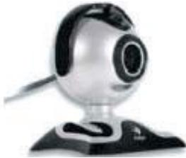
**e) La caméra vidéo** : permet de capter des images réelles et les numériser afin d'être traitées par l'ordinateur. La Web Cam est une toute petite caméra vidéo branchée sur un PC, elle est, surtout, utilisée par les internautes.
