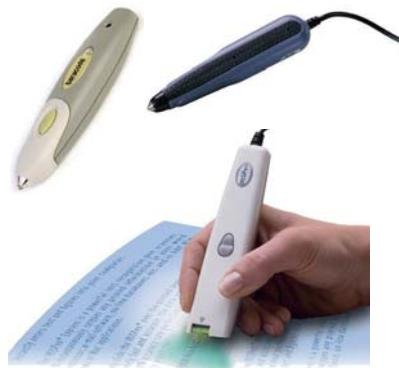
Fig. 9: Le crayon effectue une lecture par passage manuel sur le code à barres.
