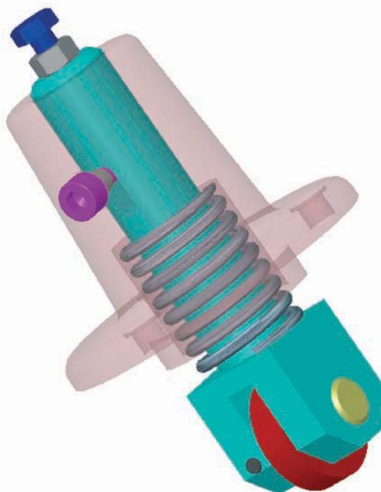
La ferrure en pente est fixée sur la porte. Elle apparaît sur le dessin d'ensemble suivant une surface inclinée en contact avec le galet (8).
